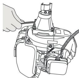
Используйте четыре винта М6 из комплекта поставки и закрепите чашку сцепления к двигателю.
