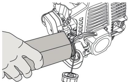
Заполните топливный бак приготовленной топливной смесью.
