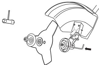
Открутите гайку, снимите чашку и крепежную шайбу диска (стопорную шайбу оставьте на валу шпинделя). Установите нож посадочным отверстием в проточку стопорной шайбы, наденьте крепежную шайбу, чашку и затяните гайкой. Прокрутите нож рукой для определения отсутствия биения. Не используйте нож при наличии несоосной установки.
