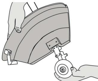
Установите кожух на крепежную площадку штанги и закрепите при помощи двух винтов М6. На защитном кожухе имеются посадочные места для установки отрезного ножа, закрепите нож тремя саморезами и убедитесь, что нож отрезает леску при ее избытке во время вращения катушки на необходимую длину. В противном случае леска создаст дополнительную нагрузку на двигатель.
