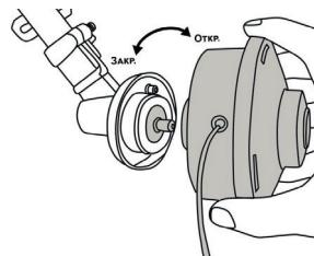
Открутите гайку, снимите чашку и крепежную шайбу диска (стопорную шайбу оставьте на валу шпинделя) и накрутите катушку и затяните её. Гайку, чашку и крепежную шайбу сохраните для крепления диска.
