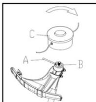
Поверните вал таким образом, чтобы одно из отверстий верхней прижимной пластины совпало с соответствующим отверстием в верхней защитной крышке (B).
