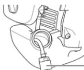
В случае нарушения подачи топлива следует проверить топливный фильтр или крышку топливного бака на предмет засорения.
