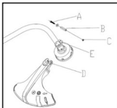
Используйте винт (A) и зафиксируйте защиту (D) на штанге (E).
