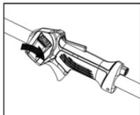
Для остановки двигателя переведите выключатель зажигания в положение «O». Запустите двигатель и убедитесь, что он останавливается после перевода выключателя в положение «O».
