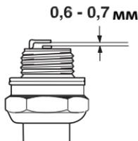
На электродах свечи зажигания могут появляться отложения, что может стать причиной ухудшения рабочих характеристик и возникновения проблем при пуске.
