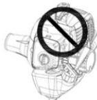
Не помещайте любые части тела в отмеченные на рисунке области. Прикосновение к указанным местам может привести к ожогам или поражению электрическим током (если поврежден свечной наконечник). Всегда используйте перчатки. Не эксплуатируйте триммер с поврежденным свечным наконечником.
