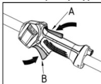
Блокиратор курка газа предотвращает случайный пуск двигателя. При нажатии на блокиратор (А) (например, при удержании рукоятки), курок (В) разблокируется. При отпуске блокиратора курок газа возвращается в исходное положение и снова блокируется. Движение блокиратора и курка газа управляется двумя независимыми возвратными пружинами, обеспечивающими автоматическую блокировку курка газа.
