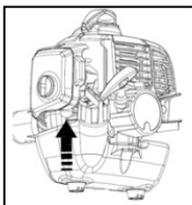
**с).** Подкачка топлива: несколько раз нажмите на ручной насос подкачки топлива, пока топливная смесь не начнет поступать в камеру. Не нужно полностью заполнять камеру топливной смесью.
