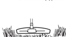
Триммер идеально подходит для стрижки травы, до которой трудно добраться обычной газонокосилкой. Во время резки располагайте леску параллельно земле. Не прижимайте триммерную катушку к земле, поскольку можно повредить не только газон, но и сам инструмент.
