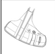
Предназначен для предотвращения выброса объектов в сторону пользователя и защиты пользователя от случайного прикосновения к режущему инструменту.
