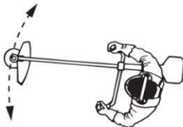
Триммер позволяет легко и быстро очистить значительную площадь. Несколько раз проведите триммер над областью, при этом держите леску параллельно очищаемой поверхности. Для достижения наилучших результатов используйте полную мощность триммера.
