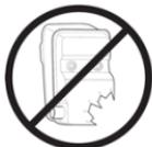
Предназначен для снижения уровня шума и отвода выхлопных газов от пользователя. Эксплуатация триммера с неисправным глушителем не допускается. Необходимо регулярно проверять надежность крепления глушителя к триммеру.
