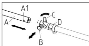
Совместите отверстие (A1) передней штанги (A) с фиксирующим штифтом (B). Затем вытяните штифт и до упора вставьте переднюю штангу в соединитель (D). Отпустите штифт, чтобы он вернулся в исходное положение и зафиксировался в отверстии на передней штанге.
